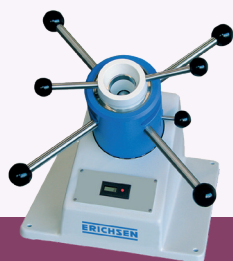
TEST ERICHSEN D'EMBOUTISSEMENT ISO 1520 Totale résistance à la déformation Opérations de pliage, cambrage possibles après traitement.
